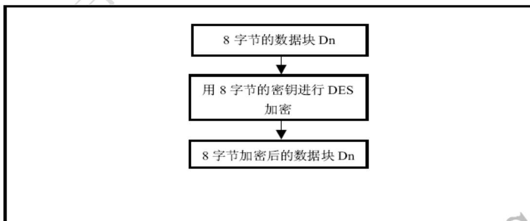
图 3.19 用Single DES密钥进行数据加密的算法
